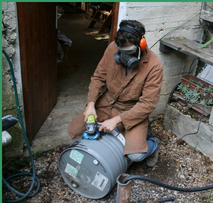
décapage du bidon métallique, corps du futur poêle
