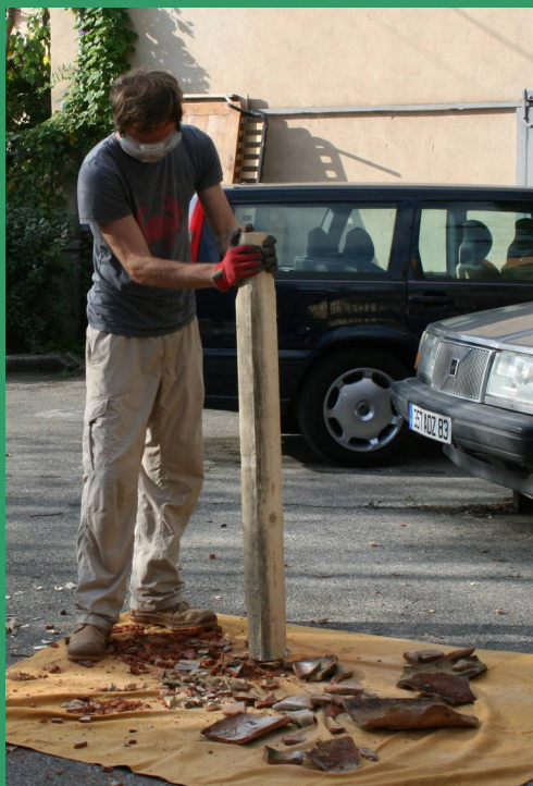
concassage de tuiles en terre pour la confection du mortier réfractaire dense
